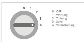
Beispiel Dimmschalter mit 4 Stufen
